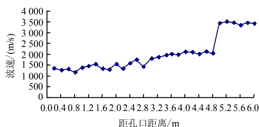
图4 两帮松动圈声波法测试结果
